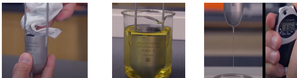
รูปที่1 แสดงถ้วยวัดความหนืด Zahn Cup และวิธีการวัดค่าความหนืด
