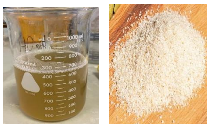
ภาพที่ 1 สารละลายโปรตีนจากขนไก่ และผงโปรตีนจากขนไก่
